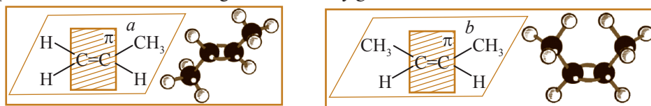
Fig. 2.36. Aranjarea substituenților ( \text{CH}_3 ) în izomerii geometrice ai But-2-enei: a – cis-But-2-enă; b – trans-But-2-enă.
